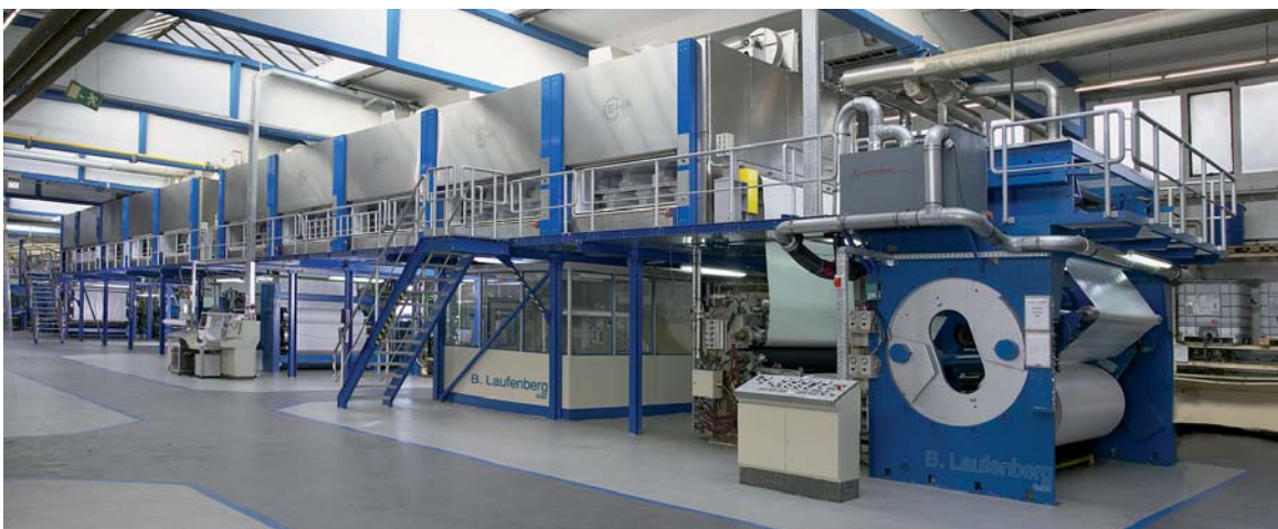
Schwebetrockner für Imprägnier- und Beschichtungsanlagen
